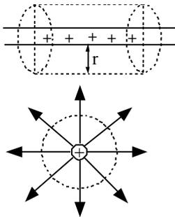
Para hallar el campo creado por este hilo en un punto A, utilizamos como superficie gaussiana una superficie cilíndrica con el centro en el hilo considerado, y cuya generatriz pase por el punto A.
