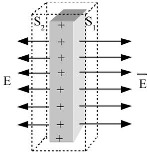
Solamente hay flujo a través de las caras  $S_1$  y  $S_2$  paralelas al plano. No olvides que se trata de un plano cargado. Por tanto, sin espesor.
